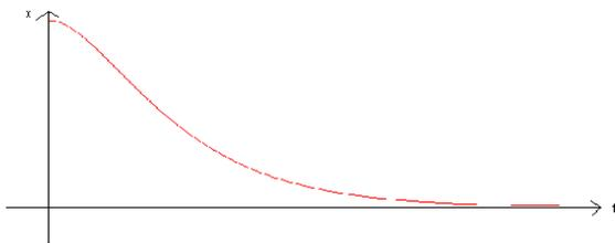
\*  $Q < \frac{1}{2}$  mouvement apériodique  $x = A e^{-\frac{t}{\tau}} \text{ch}(\sqrt{\Delta'} t + \varphi)$  avec  $\Delta' = \omega_0^2 \left( \frac{1}{4Q^2} - 1 \right)$
